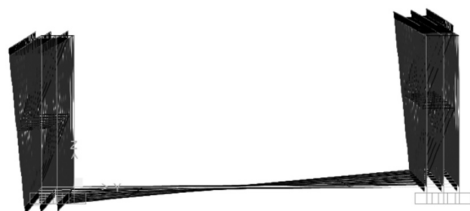
Figura 26 - Alçado frontal do 1º modo de vibração da estrutura (sem escala) [Fonte própria]
