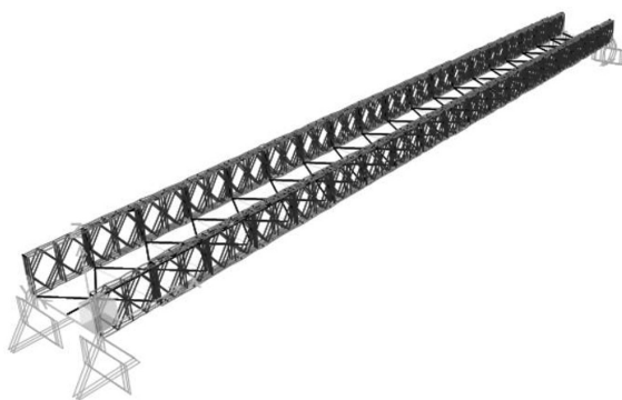
Figura 21 - Vista 3D do modelo numérico da estrutura em SAP2000 [Fonte própria]
