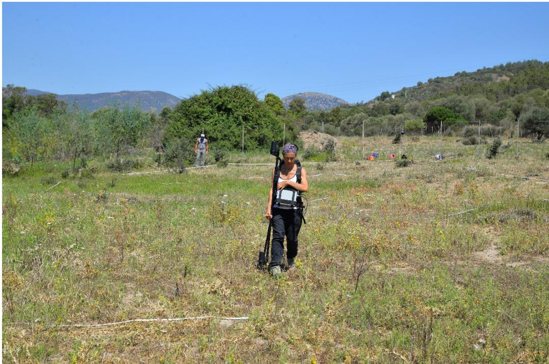
2 Mediciones del gradiente magnético vertical realizadas a lo largo de perfiles con orientación S-N (Foto R. Secci).
