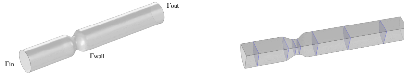
Figura 1: Esquerda: representação do domínio computacional da estenose. Direita: representação das secções, \Omega_{part} .
