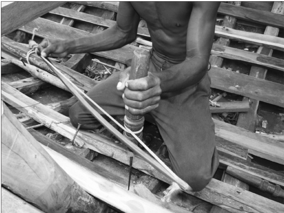
Figura 6: Verruma movida com arco (estaleiro de Nungwi)
