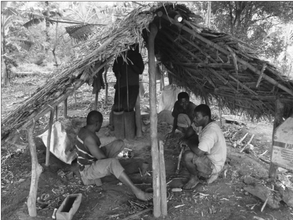
Figura 8: Forja e fabrico de cavilhas de ferro, em Nungwi
