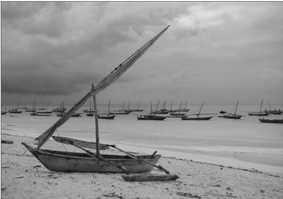
Figura 10: Dhows usados na pesca ancorados frente à praia de Nungwi. Em primeiro plano uma canoa Ngalawa, escavada em tronco de árvore, provida de estabilizadores laterais e vela triangular
