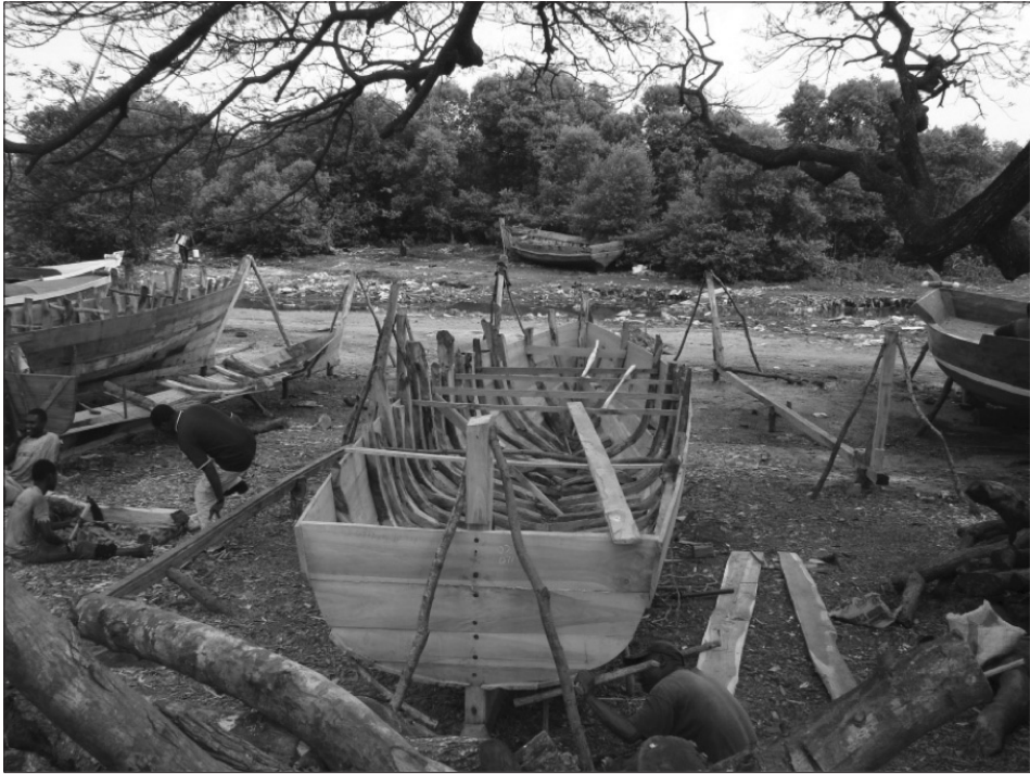
Figura 4: Construção de um mashua , no estaleiro perto de Stone Town
