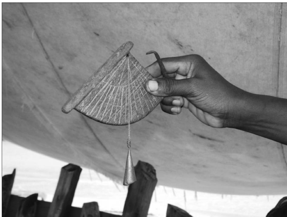
Figura 5: Inclinómetro com fio-de-prumo (estaleiro de Nungwi)
