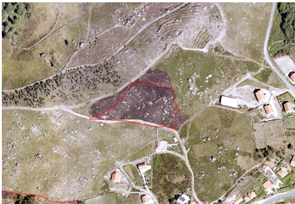
Fig. 2 – Perímetro de incêndio delineado manualmente com base em imagem de satélite (Landsat 5) para posterior correção pela sobreposição sobre ortoimagem de 2004. Figura a cores disponível online.
