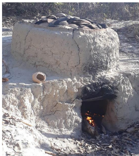
Figura 8: Forno onde são queimadas as peças. Fonte: Arquivo pessoal.
