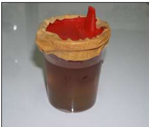
Figura 6. Frasco mal vedado, com visível extravasamento.
