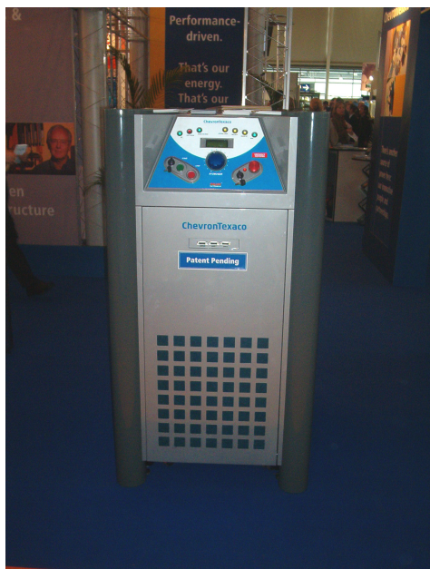
Figura 2 – Fotografia do Processador de Combustível HALIAS™ da Chevron Texaco, na Feira de Hannover em Abril de 2003. Este obtém o hidrogénio a partir do gás natural ou propano, tendo uma capacidade de produção de 120 litros / minuto, sendo a sua potência máxima de 7,5 kW e o rendimento da conversão em hidrogénio de 75%.
