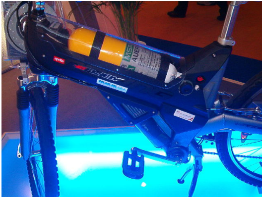
Figura 3 – Fotografia de um depósito feito de material com compostos de carbono, de armazenamento do hidrogénio sob a forma comprimida aplicado numa bicicleta eléctrica. Fotografia tirada na Feira de Hannover em Abril de 2003.
