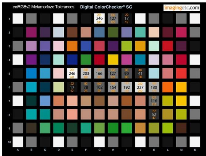
Fig. 7- Valores e tolerâncias dos neutros na *Metamorfoze* e no espaço de cor eciRGBv2 com a mira DCSG
