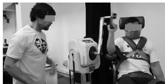
Figura 1. Realização do movimento de flexão e extensão do cotovelo no dinamómetro isocínético
