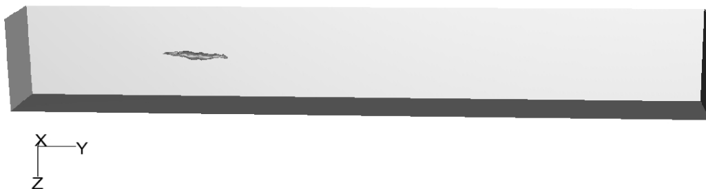
Figura 2. Domínio da simulação. Pista de uma piscina com 2 m de profundidade, 2 m de largura e 25 m de comprimento. Modelo a 1 m de profundidade.
