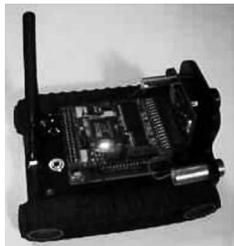
**Figura 1** - Robot ROVIM
