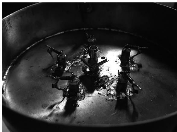
Figura 6. Vista inferior da antena com componentes eletrônicos incluídos
