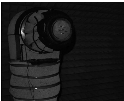
Figura 8. ESPAR fixa ao posicionador (câmara anecóica)
