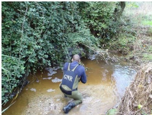
**Figura n.º 6 – Recolha de amostras em local com indícios de contaminação, apresentando espuma e coloração.**
