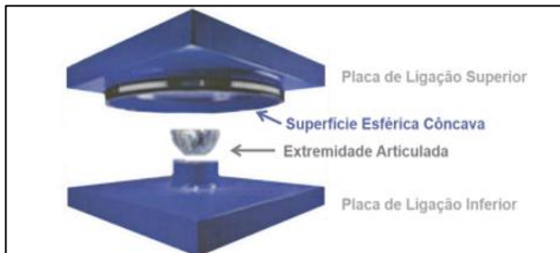
Ilustração 3: Estrutura Interna de um Apoio FPS.
