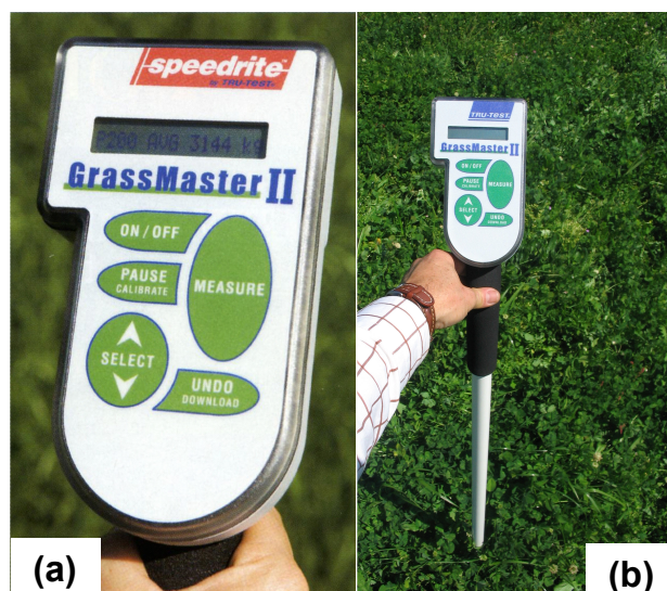
Figura 1 - “Grassmaster II”: (a) pormenor da consola; (b) sonda em operação.
