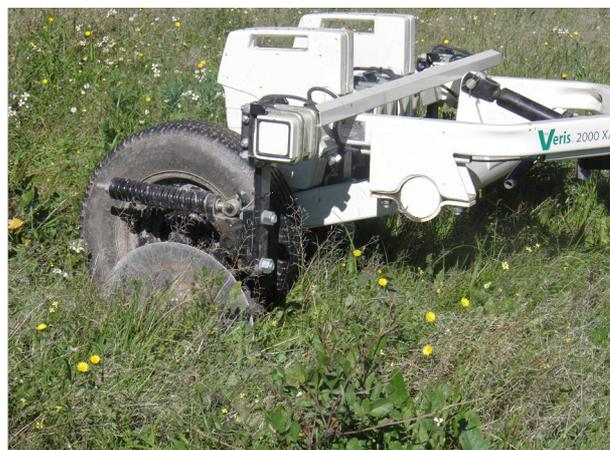
**Figura 3** - Sensor "Veris 2000 XA" para monitorização da condutividade eléctrica aparente do solo ( $CE_a$ ).
