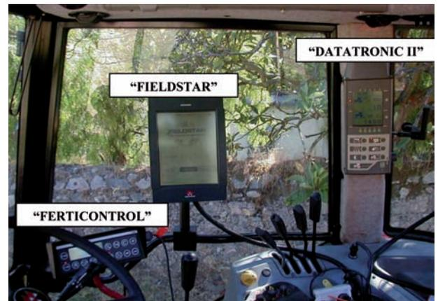
**Figura 10** – Sistemas “Ferticontrol”, “Fieldstar” e “Datatronic II” instalados no tractor Massey-ferguson 6130 utilizado nos ensaios de aplicação de fertilizante no campo experimental
