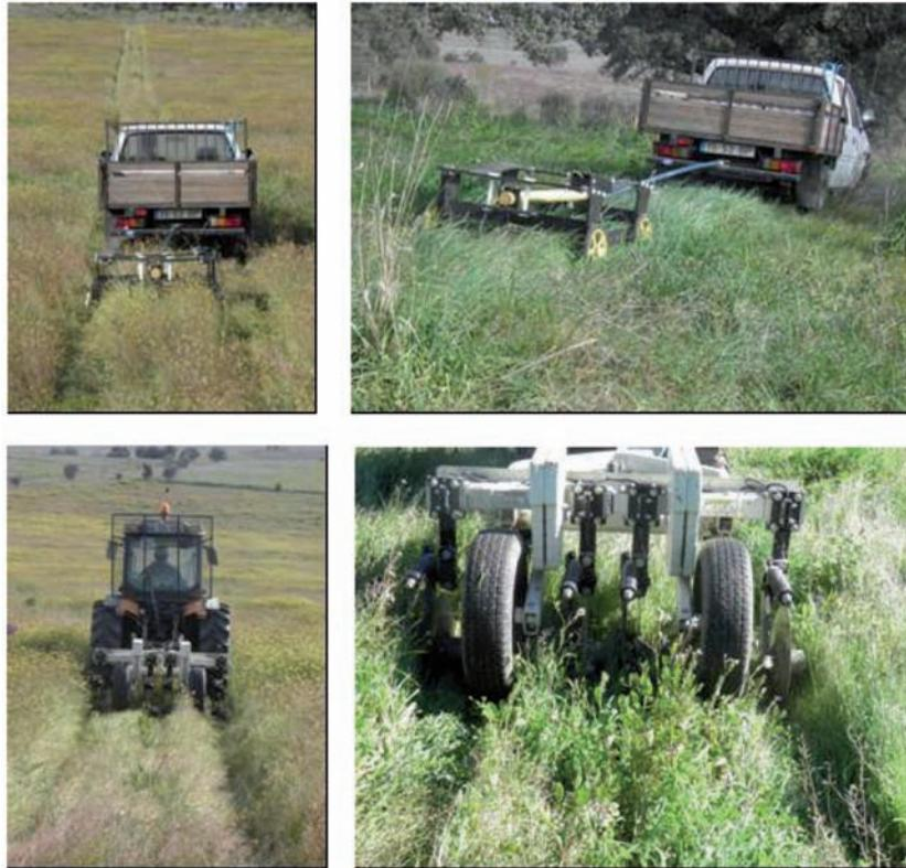
**Figura 5** – Levantamento com os sensores DUALEM-1S (em cima) e Veris 2000 XA (em baixo) no campo experimental (Fevereiro de 2012)
