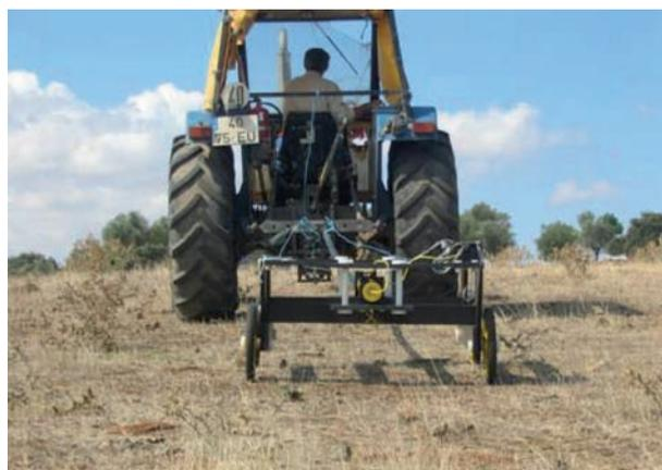
**Figura 3** – Sensor de indução electromagnética DUALEM-1S no campo experimental
