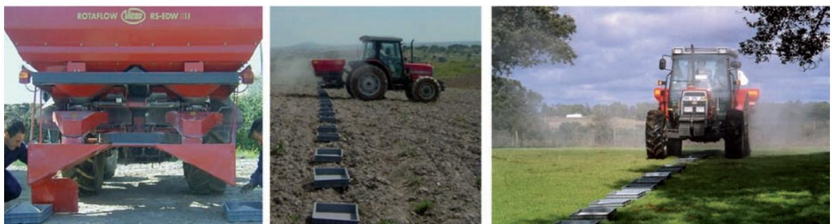
**Figura 11** – Ensaio do distribuidor de adubo Vicon RS-EDW: calibração estática (à esquerda), determinação do perfil transversal de distribuição (ao centro) e do perfil longitudinal de distribuição (à direita)
