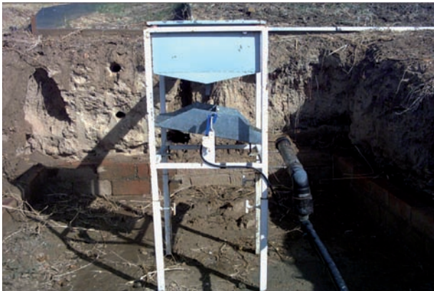
Figura 1 – Equipo basculador de cangilones montado en campo.
