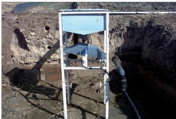
**Figura 1** – Equipo basculador de cangilones montado en campo.
