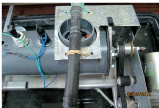
**Figura 11** – Colector con placa antigoteo.
