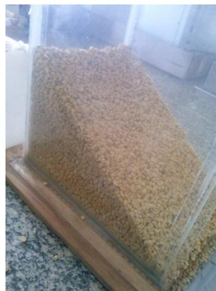
**Figura 1** - Determinação do ângulo de repouso dos grãos de soja para diferentes proporções de cotilédones e impurezas.
