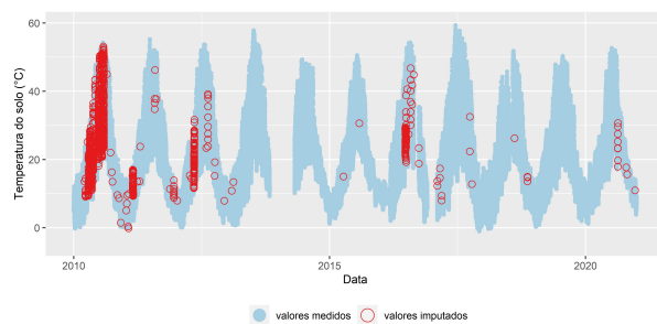
Figura 2 - Série de dados de temperatura do solo, medidos com periodicidade horária (círculos azuis-claros), recolhida na estação meteorológica de Mirandela, no período 2010-2020, e dados imputados em lacunas inferiores a 500 valores consecutivos em falta (circunferências vermelhas), usando a função na_seadec contida no pacote imputeTS .
