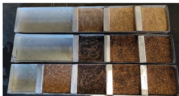
Figura 1 - Dispositivo experimental para simulação de humedecimento e secagem das amostras.
