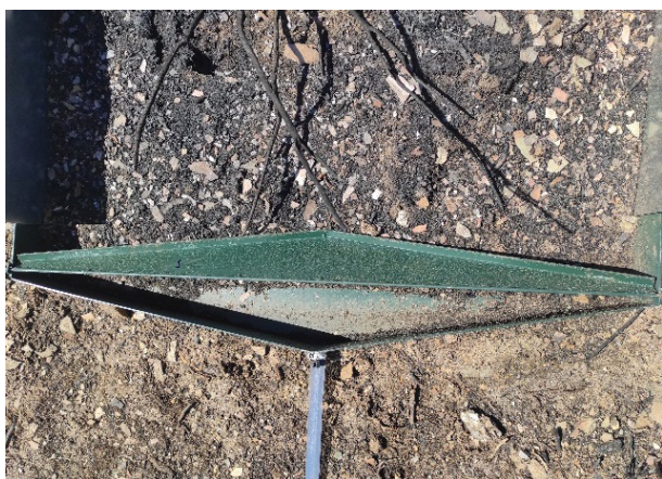
Figura 3 - Acumulação de sedimento no dispositivo colocado na frente das parcelas de erosão.
