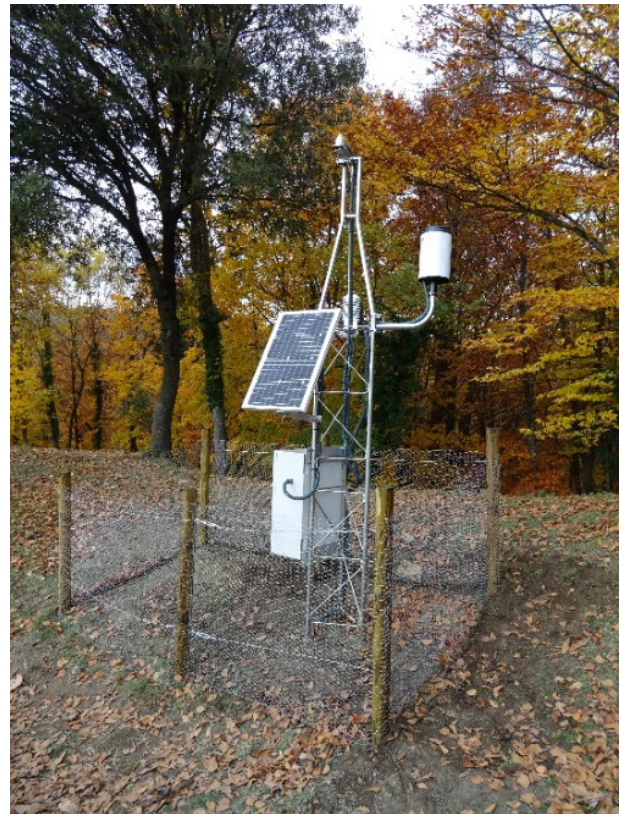
Figura 1 - Vista de una de las estaciones de la red de medida de parámetros físicos del suelo.
