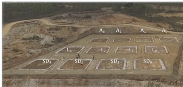
Figura 1 - Vista aérea do ensaio piloto desenvolvido na Mina de São Domingos: quatro talhões com os solos de cada uma das minas, e com os respetivos tratamentos ( https://www.lifenowaste.pt/s/ ). As letras A, L e SD, corresponde os iniciais das minas, Aljustrel, Lousal e São Domingos e os números, 1, 2 e 3, os tipos de tratamentos (GCB, GCB+LBC e CB+LB), respetivamente. O - amostras de solos das minas utilizadas como controlo (sem tratamento).
