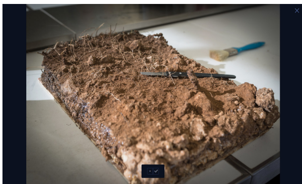
Figura 2 - Monolito resultante de uno de los perfiles considerados tras la impregnación y tallado en el laboratorio.
