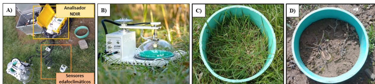
**Figura 1** - Sistema de Medição LI-8100A (A); Câmara móvel de fluxos (B); Demarcação do solo relvado (C) e do solo nu (D).
