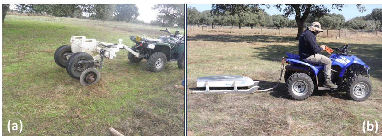
Figura 2 - Medição da condutividade elétrica aparente do solo nos campos experimentais: (a) sensor Veris 2000 XA; (b) sensor EM-38.
