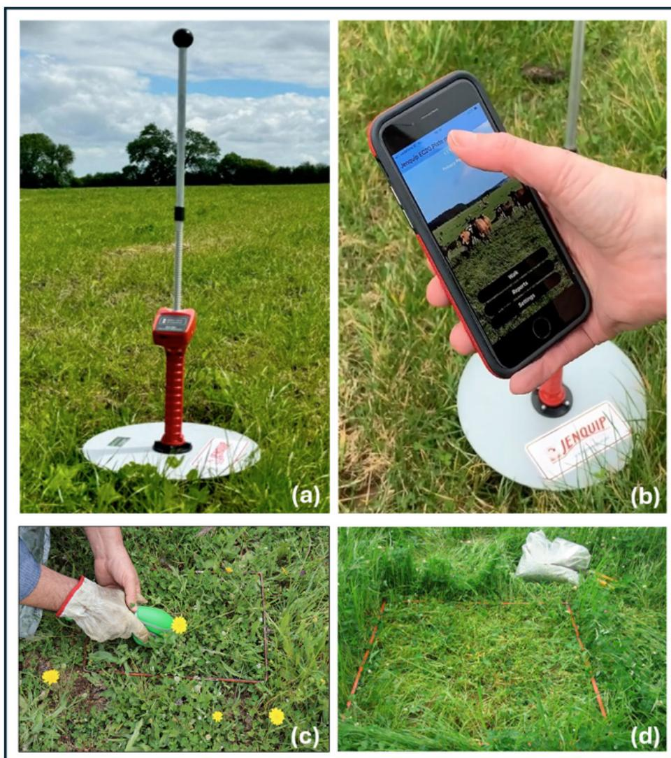
**Figura 2** - Sensor medidor de prato ascendente em operação na pastagem (a); leitura dos registos da medição do sensor na aplicação no telemóvel (b); corte da pastagem com tesoura elétrica (c); aro delimitador da área de corte (d).
