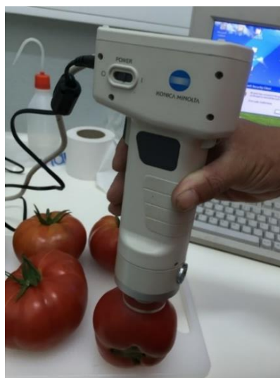
Figura 2: Leitura da cor da epiderme do fruto com colorímetro.
