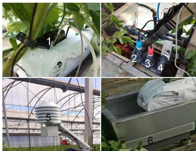
Figura 5: Conjunto dos sensores do equipamento (1- sonda RESIPREL PT-100; 2- sonda PH HI1001; 3- sonda EC HI3002; 4- pluviómetro de báscula PM1; 5- sonda DHT22; 6- célula de carga RSC-1)
