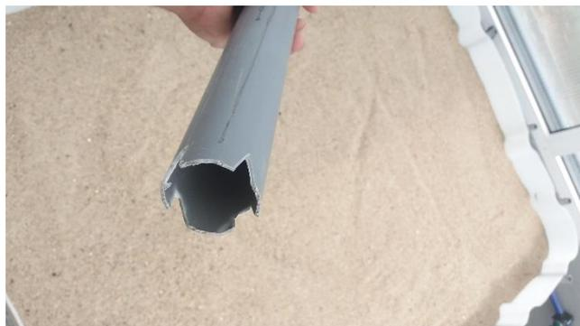
*Figura 4:* Tubo com função de "caixa de visita".
